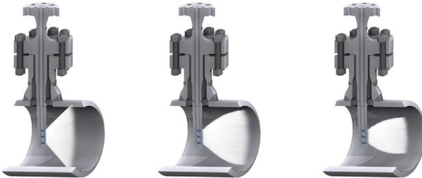
Figure 7.3 Pénétration du jet du désurchauffeur
