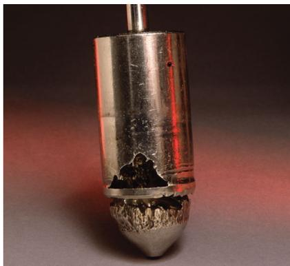
Figure 5.8 Aspect type des dommages de la détente
