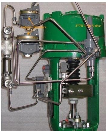
Figure 4.8 Installation type d'amplificateurs avec actionneur double effet
