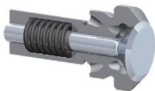
Figure 7.11 Buse de vaporisation à géométrie variable actionnée par la contre-pression
