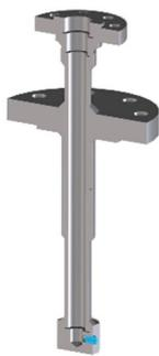
Figure 7.4 Conception d'une buse à géométrie fixe
