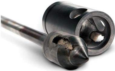
Figure 5.9 Aspect type des dommages de la cavitation
