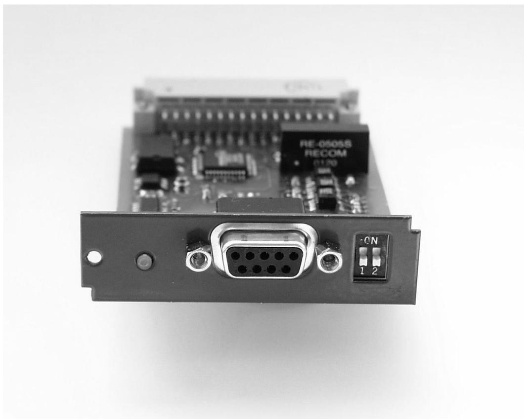
**Figure 30: SE-Power Profibus Interface : vue de devant**
