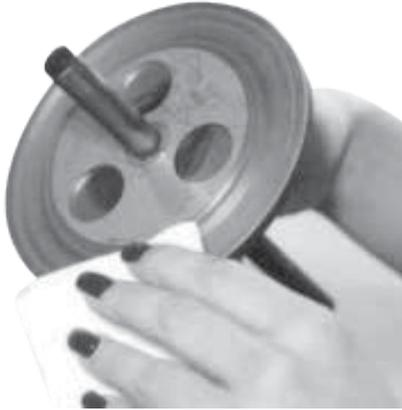
3. Vérifier que les palettes ne présentent pas de dommages ou de dépôts susceptibles d'affecter leurs caractéristiques d'étanchéité ou leur capacité à se déplacer correctement à l'intérieur de la soupape. Si nécessaire, nettoyer délicatement la palette et le joint à l'aide d'un solvant approprié et d'un chiffon non abrasif.
