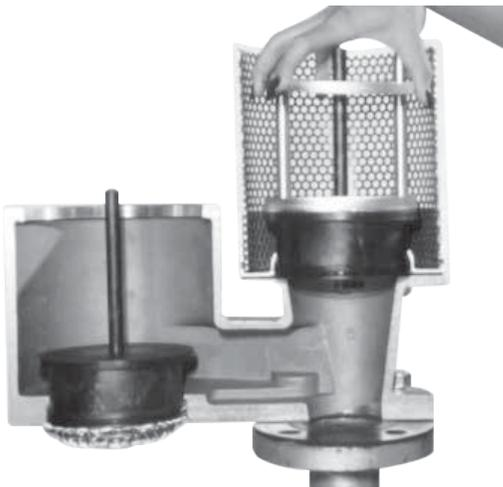
9. Réinstaller les masses sur les palettes de soupape appropriées.
