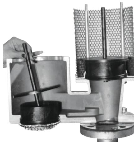
3. Réintroduire les palettes non couvertes de la soupape dans l'appareil. S'assurer que la tige inférieure de la palette est centrée dans le siège de la soupape. Si la palette semble être décentrée par rapport à la chambre de la soupape, ou s'il est difficile de positionner le couvercle ou le guide, inspecter soigneusement la palette pour s'assurer qu'elle est correctement introduite.
