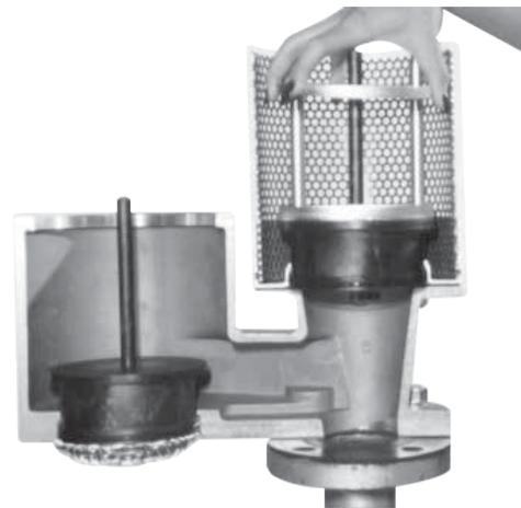
2. Retirer les palettes de soupape et les masses de l'appareil. Garder à l'esprit qu'elles seront réinstallées, il convient donc de noter la chambre d'où elles ont été retirées.
