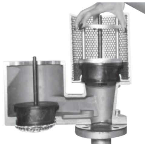
5. Réinstaller les palettes de pression et/ou de dépression dans leurs ouvertures respectives. Installer les masses de
