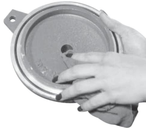
6. Si la soupape comporte un couvercle, nettoyer toute accumulation pouvant se trouver à l'intérieur ou autour de l'orifice de guidage situé au centre de la pièce.
