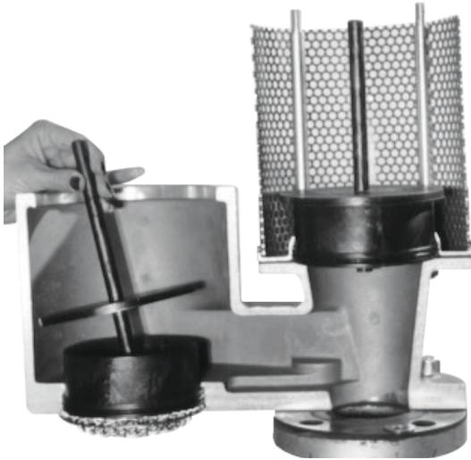
8. Réinstaller les palettes de soupape et les masses dans leurs chambres respectives. S'assurer que la tige inférieure de la palette est centrée dans le siège de la soupape. Si la palette semble être décentrée par rapport à la chambre de la soupape, ou s'il est difficile de positionner le couvercle ou le guide, il se peut que l'introduction de la palette ne soit pas correcte.
