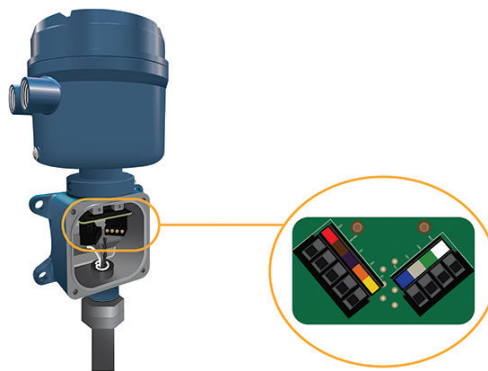
Illustration 3-4 : Raccordement du câblage à 9 conducteurs du transmetteur au capteur
