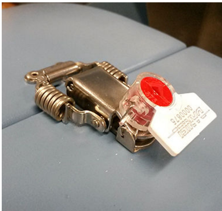
Illustration 3-26 : Fermeture du capot avec scellé de sécurité
