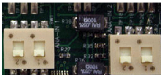
Figure 3-25: Réglages d'usine des commutateurs d'entrée analogique
