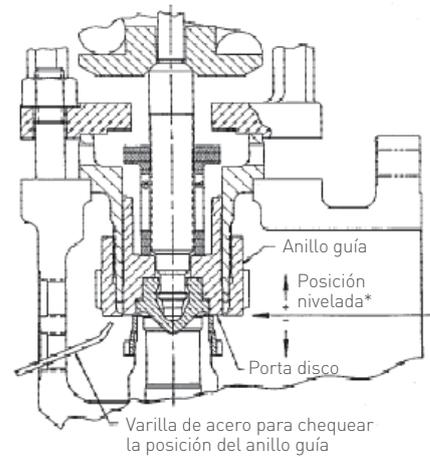
\* Puntos de ajuste de fábrica y dientes (+/-) de posición de anillo guía del nivel estampado en el bonete
