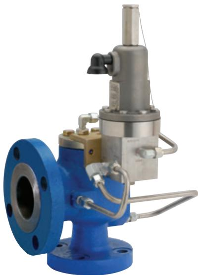
o piloto alivia, despressurizando o volume acima do êmbolo, a cúpula da válvula principal e o êmbolo eleva-se, permitindo a descarga a partir da válvula principal. Assim que o alívio de capacidade do sistema é atingida, a pressão do sistema começa a diminuir. Quando isso acontece, o piloto actua e dirige a pressão do sistema para a cúpula da válvula principal. Esta acção fecha a válvula principal.
