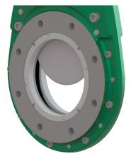
Prolongue a vida útil de suas válvulas com anéis de desgaste endurecidos de entrada e saída padrão para proteger os elementos de vedação e o corpo contra lama abrasiva. Esses anéis Ni-Resist duráveis podem ser girados 3 vezes em 4 posições para estender a vida útil da válvula e os intervalos de substituição, permitindo que você melhore a utilização de seus ativos e a produtividade do processo.
