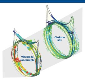
Execute seus processos por mais tempo com um projeto de válvula otimizado para prosperar em condições de lama pesada. Uma porta totalmente redonda elimina saliências no fluxo, minimizando a turbulência na válvula para estender a vida útil do corpo. Isso não apenas garante a longevidade dos componentes de vedação, mas também minimiza os impactos prejudiciais da lama no equipamento da tubulação a jusante.
