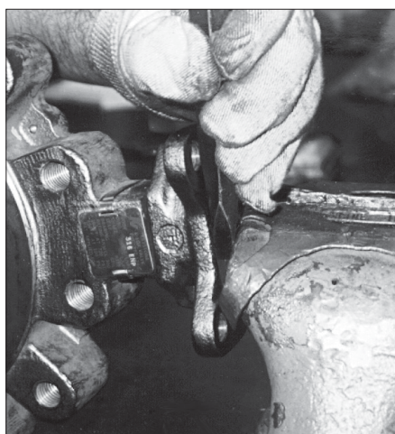
Figure 2 - Dépose de l'arbre supérieur du moyeu du disque supérieur.
