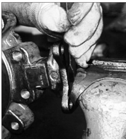
Figure 2 - Procédure de dépose de l'arbre supérieur du moyeu du disque supérieur.
