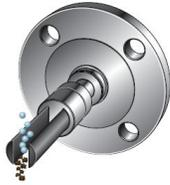
2. Das T-Stück ist so zu dimensionieren, dass der Abstand zwischen der Gabel des Messsystems und der Hauptrohrleitungswand 25 mm (1 Zoll) beträgt. Im Fall höherer Durchflussraten ist dieser Abstandswert pro Erhöhung des Hauptdurchflusses von 1 m/s um jeweils 10 mm (0,4 Zoll) zu erhöhen.
