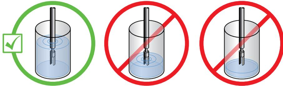
5. Es muss sichergestellt werden, dass bei der Positionierung des Messsystems die Möglichkeit des Durchbiegens des Behälterdeckels in Betracht gezogen wurde, um zu verhindern, dass das Messsystem gegen eine Behälterwand oder in einen Bereich mit gestörtem Strömungsprofil gedrückt wird.
