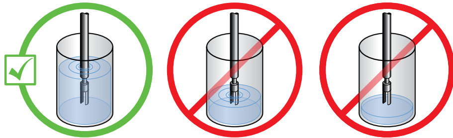
Figura 2-14: Posizionamento del misuratore (immerso nel fluido)
