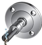
**Figura 2-10: Instalação do medidor em "T" (conexão weldolet)**
