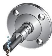
2. Dimensione a peça em "T" de modo que as pontas do medidor tenham um recuo de 25 mm (1") a partir da parede do tubo principal. Para vazões mais altas, aumente esta distância em 10 mm (0,4") para cada 1 m/s de aumento na vazão.
