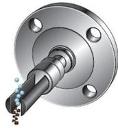
2. Dimensione la pieza T de modo que las puntas del medidor queden a 25 mm (1 in) de la pared de la tubería principal. Con velocidades mayores, aumente este valor en 10 mm (0,4 in) por cada aumento de 1 m/s en la velocidad del caudal principal.
