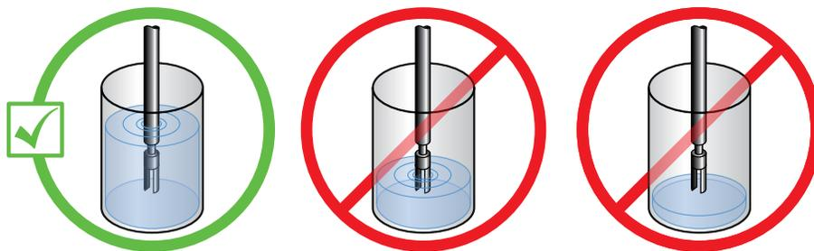
5. Confirme que la colocación del medidor permita que la tapa del tanque se curve, a fin de evitar que el medidor sea empujado hacia una pared del tanque o dentro de la trayectoria del caudal con perturbaciones.
