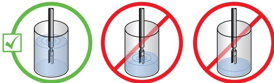
4. Confirme que las puntas del medidor estén colocadas lejos de objetos y de caudal con perturbaciones.
