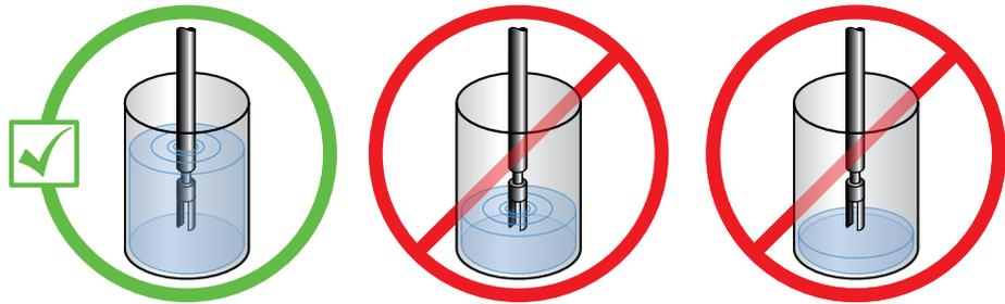
5. Achten Sie darauf, dass die Messsystem Platzierung das Durchbiegen des Tankdeckels ermöglicht ohne dass das Messsystem an die Tankwand gedrückt wird oder in eine unruhigen Strömung gerät.
