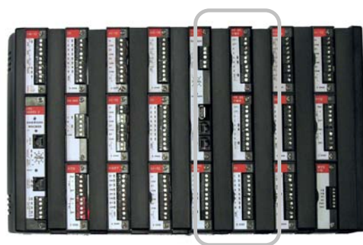
Figura 9. FFI insertado en ROC827
