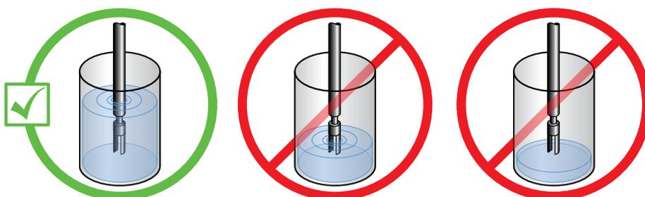
5. Accertarsi che la posizione del misuratore consenta la flessione del coperchio del serbatoio per evitare che il misuratore venga spinto verso una parete del serbatoio o nel percorso del liquido disturbato.
