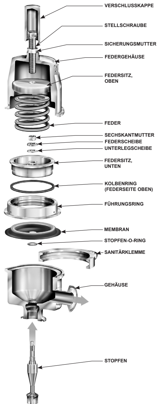
Abbildung 3. Typ SR5 Teile – Explosionsdarstellung
