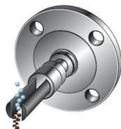
**Illustration 2-1 : Installation de l'appareil en écoulement libre (montage à bride)**
