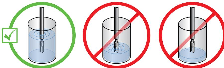
5. Vérifier que l'emplacement de l'appareil tient compte des déformations du couvercle de la cuve, et que celles-ci ne risquent pas d'amener le diapason trop près d'une paroi de la cuve ou d'une perturbation d'écoulement.
