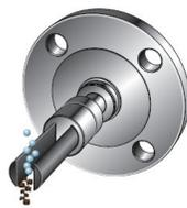
2. Dimensionner la tubulure en T pour que les lames du diapason soient en retrait de 25 mm (1") par rapport à la paroi de la tuyauterie principale. Pour les vitesses supérieures, augmenter le retrait de 10 mm (0,4") pour chaque m/s additionnel dans la tuyauterie principale.
