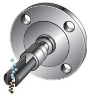
**Illustration 2-5 : Installation de l'appareil en écoulement libre (montage sur weldolet)**
