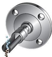
2. Размер тройника должен быть таким, чтобы зубцы вилки измерительного устройства выступали на 25 мм (1 дюйм) из стенки основного трубопровода. В случае более высокого расхода увеличивайте этот размер на 10 мм (0,4 дюйма) на каждый 1 м/с увеличения расхода в основном трубопроводе.
