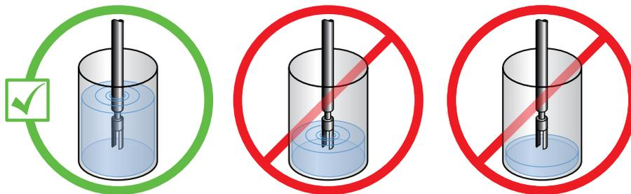
5. Убедитесь в том, что размещение измерительного устройства позволяет изгибать крышку резервуара так, чтобы измерительное устройство не смещалось в сторону стенки резервуара или туда, где протекает возмущенный поток.
