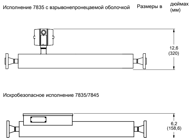
Рис. 1-8: Размеры плотномера 7835/7845 (только высота)
