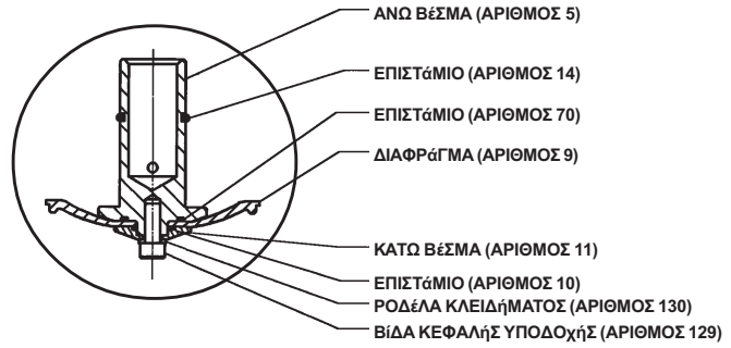
ΣΥΓΚΡΟΤΗΜΑ ΔΙΑΦΡΑΓΜΑΤΟΣ DN 25 ΚΑΙ 50 X 25 (1 ΚΑΙ 2 X 1 INTΣΑ)
