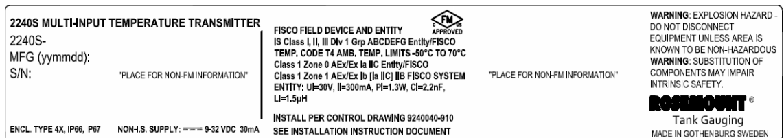
Figura B-1. Etichetta Factory Mutual US che certifica la sicurezza intrinseca
