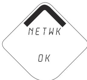
**Schermata Diagnostic Button (Pulsante diagnostico) 4:** il dispositivo si è connesso a una rete, è stato completamente configurato e ha più dispositivi principali
