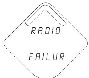
**Schermata Diagnostic Button (Pulsante diagnostico) 8:** il dispositivo potrebbe non essere in grado di comunicare con la radio oppure la radio presenta un errore interno. In questo stato il dispositivo può ancora essere operativo e pubblicare dati HART
