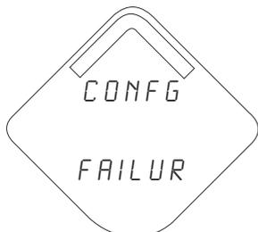
**Schermata Diagnostic Button (Pulsante diagnostico) 9.1:** la configurazione del trasmettitore non è valida, tanto che il funzionamento critico del dispositivo potrebbe essere compromesso - controllare lo stato di configurazione estesa per identificare quali voci di configurazione devono essere corrette
