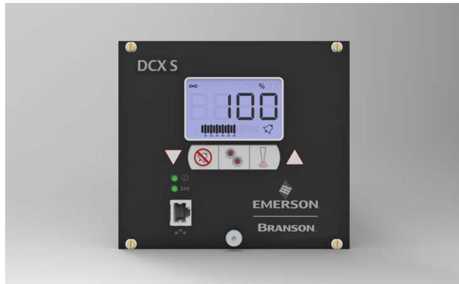
Il Generatore DCX S genera energia elettrica ultrasonica tramite un convertitore di ultrasuoni per la saldatura di materiali plastici. Sono disponibili diversi modelli a seconda della frequenza desiderata (ad esempio 20 kHz) o della gamma di potenza desiderata (ad esempio 4,0 kW). Il generatore contiene inoltre un modulo controllore a microprocessore che esegue il controllo e il monitoraggio delle operazioni di saldatura.
