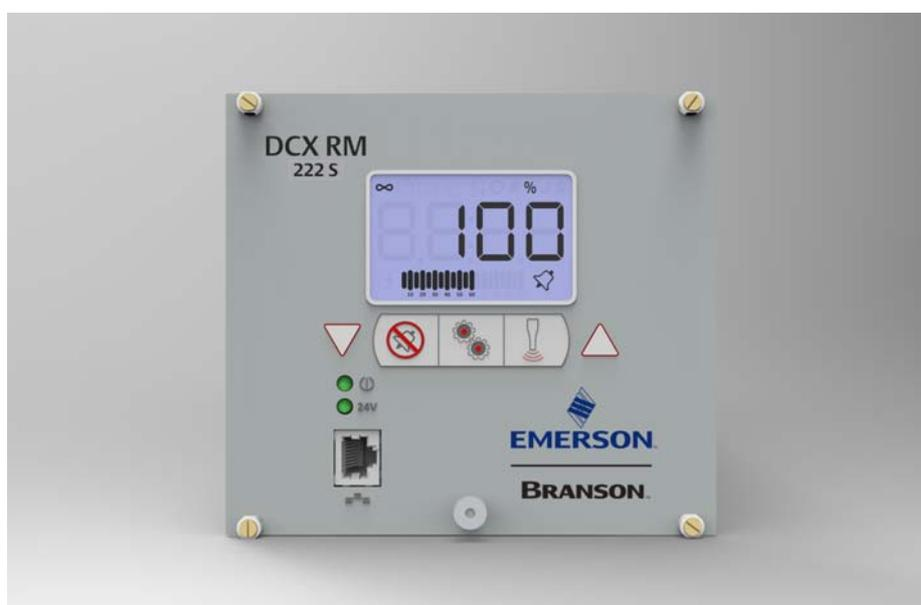
Il Generatore DCX RM S genera energia elettrica ultrasonica tramite un convertitore di ultrasuoni per la saldatura di materiali plastici. Sono disponibili diversi modelli a seconda della frequenza desiderata (ad esempio 20 kHz) o della gamma di potenza desiderata (ad esempio 4,0 kW). Il generatore contiene inoltre un modulo controllore a microprocessore che esegue il controllo e il monitoraggio delle operazioni di saldatura.
