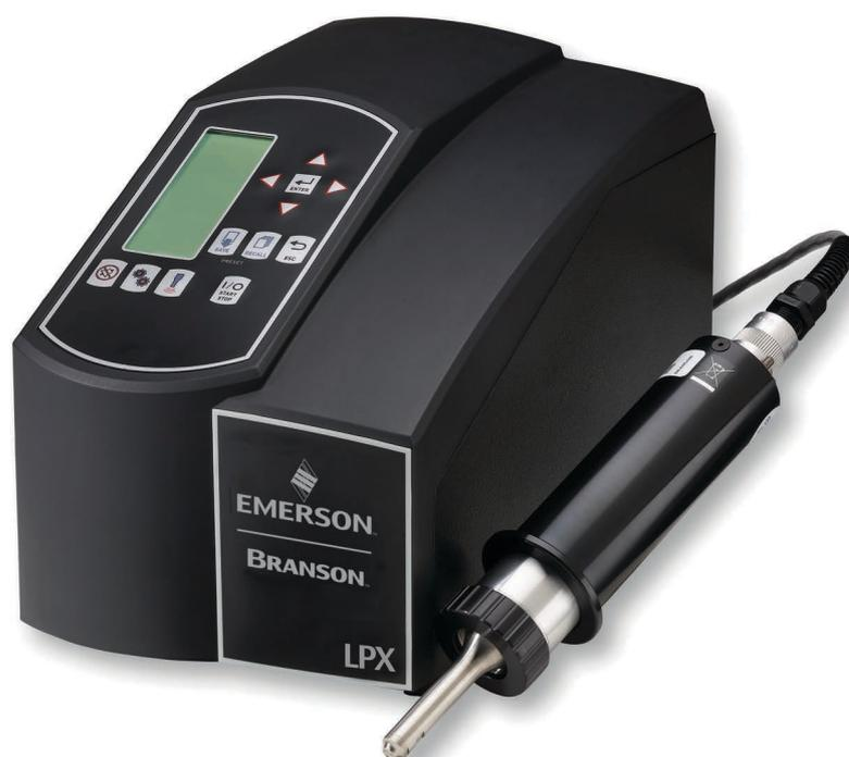
Il generatore LPX è un dispositivo ad ampiezza costante. Man mano che il carico o la pressione sul lato frontale del sonotrodo aumenta, il generatore sviluppa una maggiore potenza per mantenere l'ampiezza impostata. Quando il sonotrodo viene azionato in aria, è necessaria una potenza minima per mantenere l'ampiezza.
