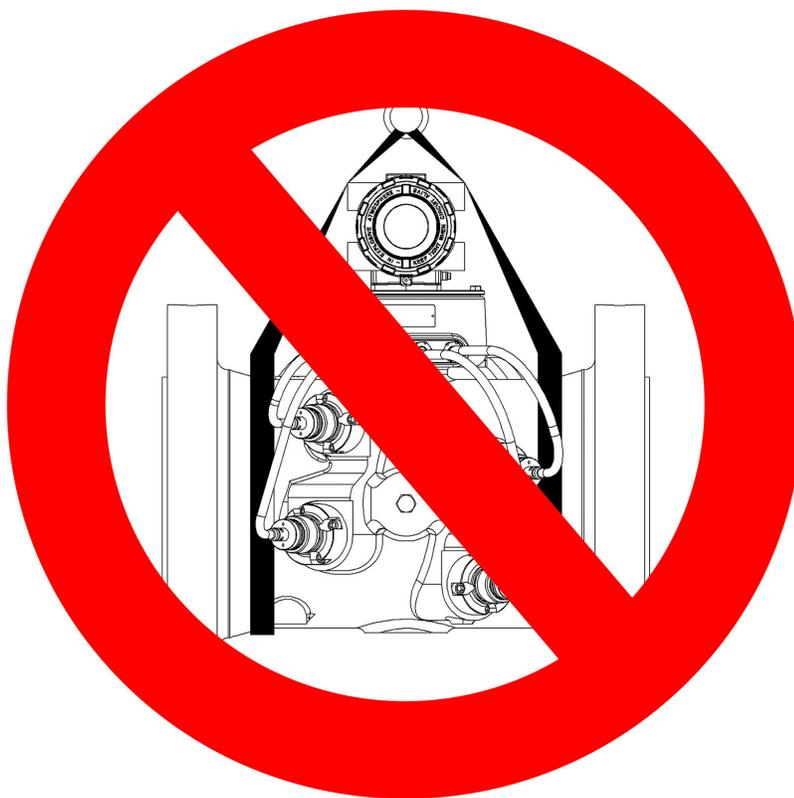
8. NON applicare MAI carichi d'urto al misuratore. Sollevare sempre il misuratore gradualmente. In caso di carico d'urto, le imbracature devono essere ispezionate secondo le procedure del produttore prima di essere utilizzate di nuovo.
