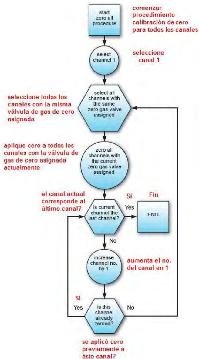
Fig. 7-4: Diagrama de Flujo del Procedimiento de Calibración de Cero para Todos los Canales
