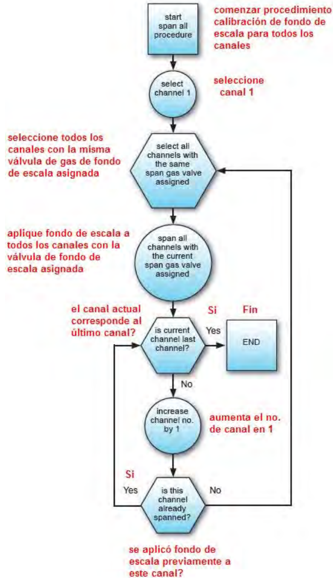
Fig. 7-5: Diagrama de Flujo del Procedimiento de Calibración de Fondo de Escala para Todos los Canales
