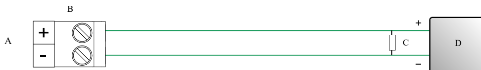
Figura 3-4: Fiação de saída em mA (alimentada internamente)
