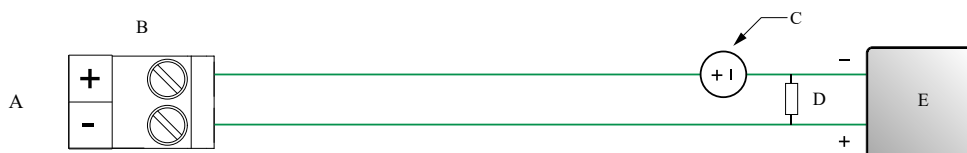
Figura 3-19: Fiação de saída discreta (alimentada externamente)
