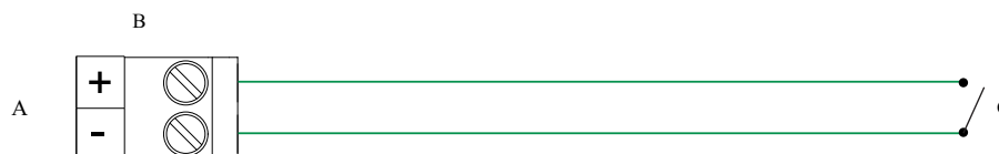
Figura 3-20: Fiação de entrada discreta (alimentada internamente)
