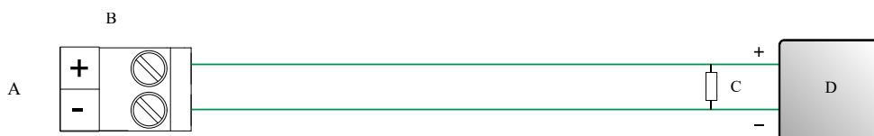
Figura 3-17: Fiação de saída discreta (alimentada internamente)
