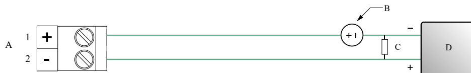
Figura 3-8: Fiação de saída em mA/HART (alimentada externamente)
