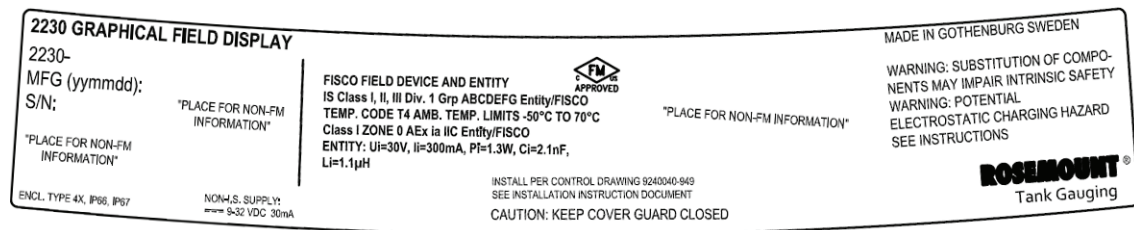
Figura B-2. Etiqueta de aprobación de seguridad intrínseca de Factory Mutual, canadiense
