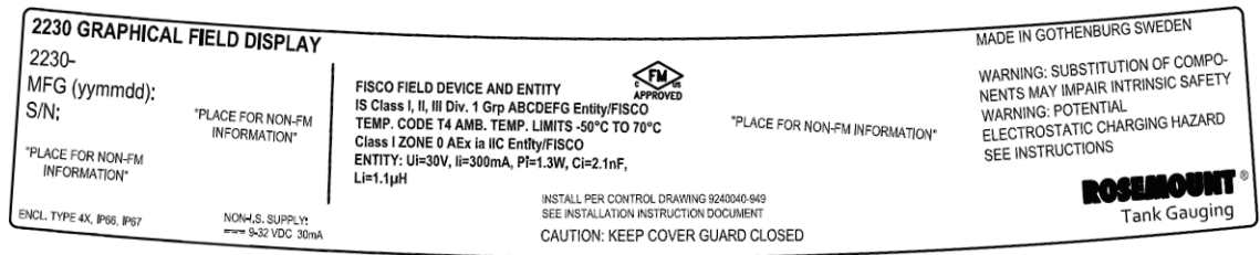
Figura B-1. Etiqueta de aprobación de seguridad intrínseca de Factory Mutual, EE.UU.
