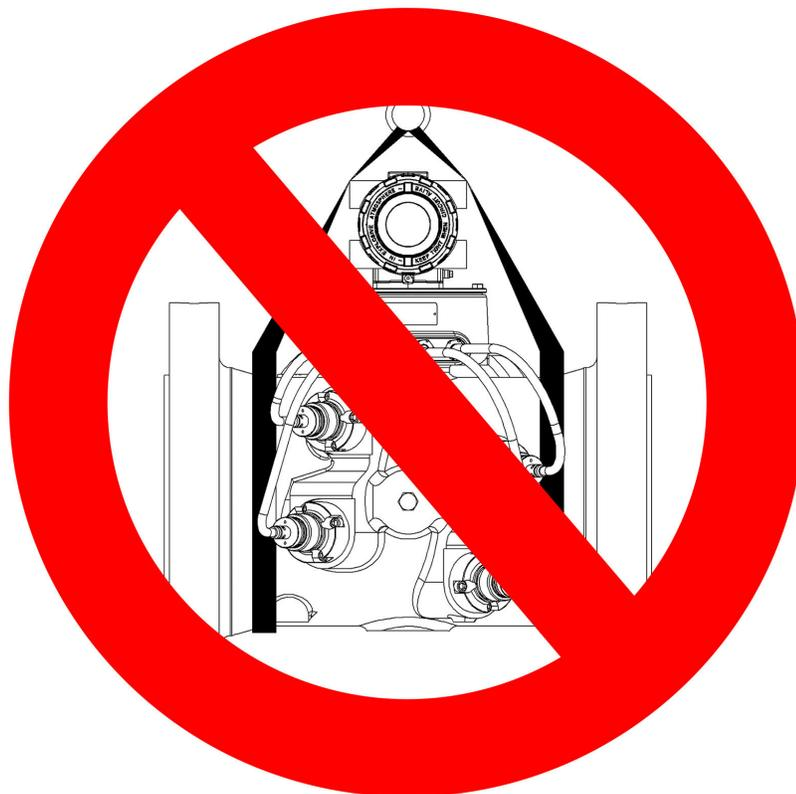
8. NUNCA aplique cargas de choque ao medidor. A elevação do medidor precisa ser sempre de forma gradual. Caso ocorram cargas de choque, as cintas de elevação deverão ser inspecionadas de acordo com os procedimentos do fabricante antes de serem usadas novamente.
