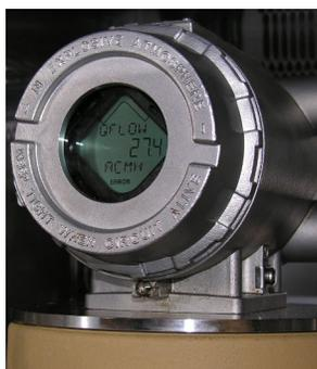
Todas as certificações de segurança U.L. do medidor de vazão de gás ultrassônico Rosemount são obtidas por meio da combinação de um invólucro de componentes eletrônicos do transmissor à prova de explosão que acomoda o módulo de CPU, a placa de alimentação, a placa da barreira de segurança intrínseca, a placa backplane e a placa opcional do display LCD.
