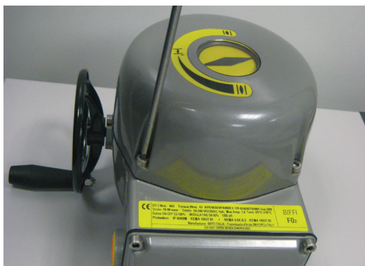
Рисунок 14 Снятие крышки блока управления
