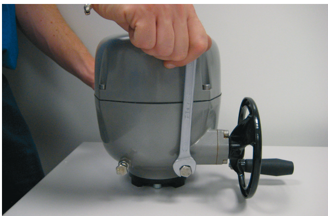
Рисунок 8 Настройка механического ограничителя хода
