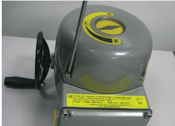
Figura 14 Remoção da cobertura da unidade de controle
