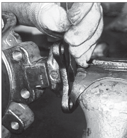
Figura 2 - Modalità di rimozione dell'albero superiore dal mozzo del disco superiore.
