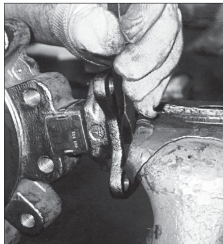
Figura 2 - Extracción del eje superior del buje de disco superior.
