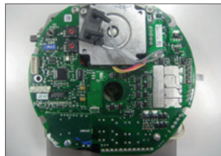
Figura 54 Esempio di EPI-2 nuova versione (dissipatore assente)
