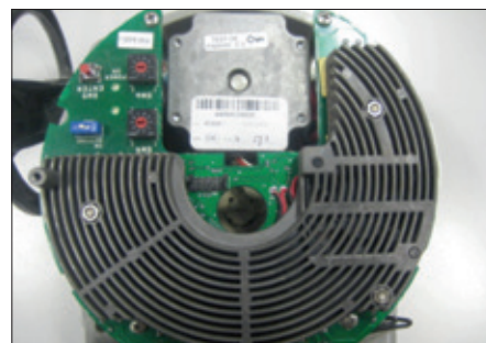
Figura 53 Esempio di EPI-2 vecchia versione (dissipatore presente)
