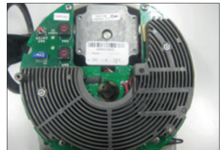
Abb. 53 Beispiel für alte EPI-2-Ausführung (mit Kühlkörper)
