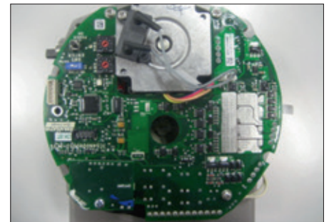
Abb. 54 Beispiel für neue EPI-2-Ausführung (ohne Kühlkörper)
