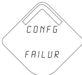
**Pantalla del botón de diagnóstico 9.1:** la configuración del transmisor no es válida y puede afectar al funcionamiento crítico del dispositivo. Comprobar el estatus de la configuración extendida para identificar qué elemento(s) de la configuración necesita(n) ser corregido(s)
