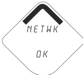
**Pantalla del botón de diagnóstico 4.9** el dispositivo se ha conectado a una red y se ha configurado completamente y tiene varios dispositivos principales.
