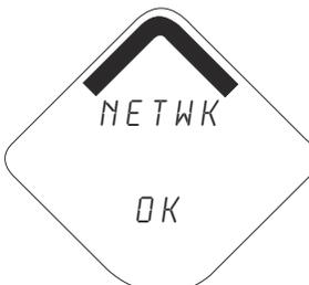
**Pantalla del botón de diagnóstico 4** el dispositivo se ha conectado a una red y se ha configurado completamente y tiene varios dispositivos principales.
