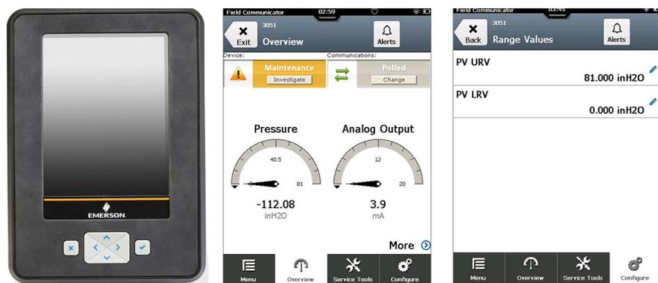
**Figura 4-16: Após a redefinição de faixa usando o comunicador de campo**
