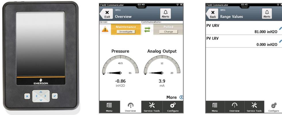
Figura 4-11: Após o ajuste de zero usando o comunicador de campo
