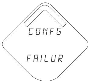
**Tela do botão de diagnóstico 9.1:** a configuração do transmissor é inválida de modo que a operação crítica do dispositivo possa ser afetada. Verifique o status de configuração estendida para identificar quais itens de configuração precisam ser corrigidos
