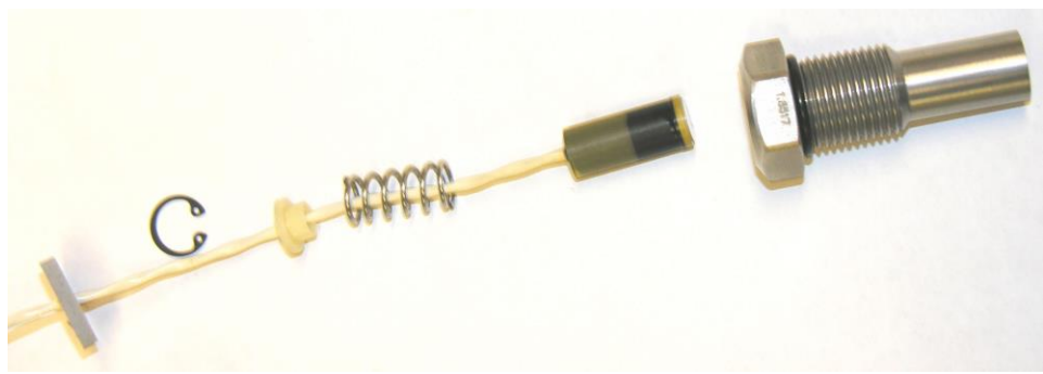
Figura 3-33: Transdutor LT-10 e conjunto do cabo removido do medidor
