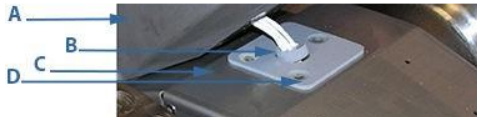
Figura 3-28: Vedação e junta do cabo do transdutor da cobertura dividida
