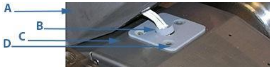
Figura 3-37: Vedação do cabo da cobertura superior
