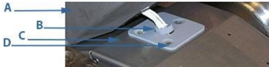
Figura 3-47: Vedação e junta do cabo do transdutor da cobertura dividida
