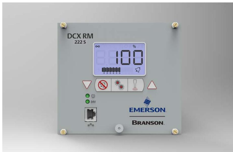
El Generador de ultrasonidos DCX RM S genera energía ultrasónica, a través de un convertidor de ultrasonidos, para soldar plásticos. Hay disponibles varios modelos, dependiendo de la frecuencia deseada (por ejemplo, 20 kHz) y del rango de potencia deseado (por ejemplo, 4,0 kW). El generador de ultrasonidos también contiene un módulo controlador basado en microprocesador que proporciona control y monitorización de las operaciones de soldadura.
