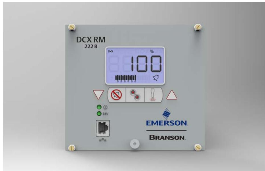
El Generador de ultrasonidos DCX RM genera energía ultrasónica, a través de un convertidor de ultrasonidos, para soldar plásticos. Hay disponibles varios modelos, dependiendo de la frecuencia deseada (por ejemplo, 20 kHz) y del rango de potencia deseado (por ejemplo, 4,0 kW). El generador de ultrasonidos también contiene un módulo controlador basado en microprocesador que proporciona control y monitorización de las operaciones de soldadura.
