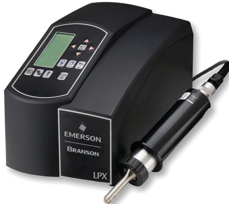
El generador de ultrasonidos LPX es un dispositivo de amplitud constante. A medida que la carga o la presión sobre la superficie del sonotrodo aumenta, el generador de ultrasonidos aumenta la potencia para mantener la amplitud ajustada. Cuando se utiliza el sonotrodo en un medio aéreo, sólo es necesaria una potencia mínima para mantener la amplitud.
