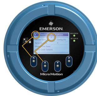
**Figura 9-3: Ejemplo 2: indicadores de flecha activos en la pantalla del transmisor**
