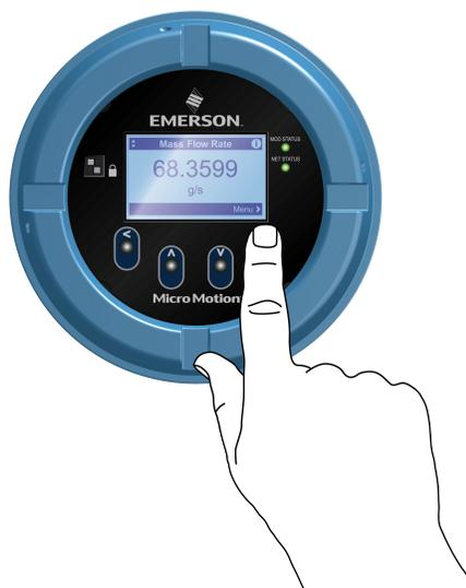
2. Use los indicadores de flecha en la pantalla de visualización para identificar qué interruptor óptico usar para navegar por la pantalla (vea los ejemplos 1 y 2).
