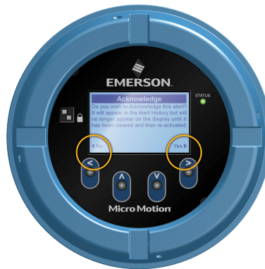
Figura 8-3: Ejemplo 2: indicadores de flecha activos en la pantalla del transmisor
