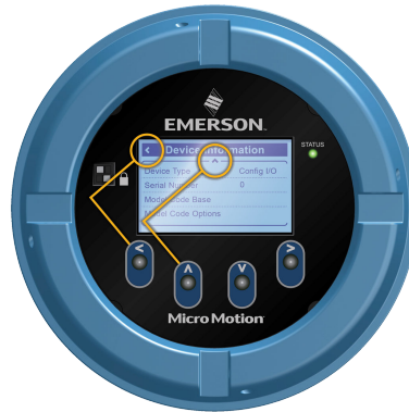
Figura 8-2: Ejemplo 1: indicadores de flecha activos en la pantalla del transmisor
