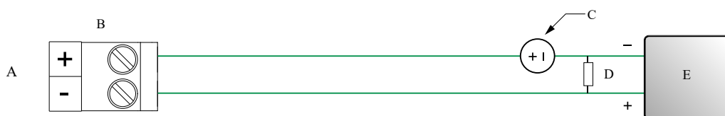
Figura 4-4: Cableado de salida de mA
