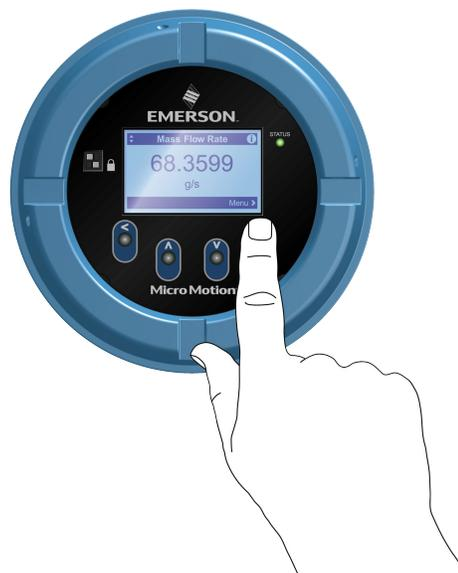
2. Use los indicadores de flecha en la pantalla de visualización para identificar qué interruptor óptico usar para navegar por la pantalla (vea los ejemplos 1 y 2).
