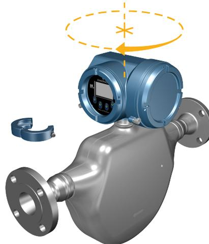
3. Baje con delicadeza el transmisor para colocarlo en la base y confirme que esté en posición bloqueada.
