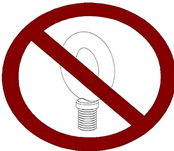
Figura 2-7: Cáncamo no conforme
